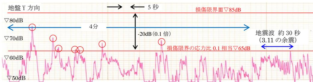
図-2 工事振動の加速度レベル波形
