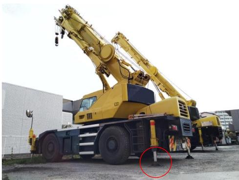
写真1 ラフタークレーンとアウトリガーの接地状況
