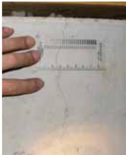
クラックスケールによるひび割れ測定
