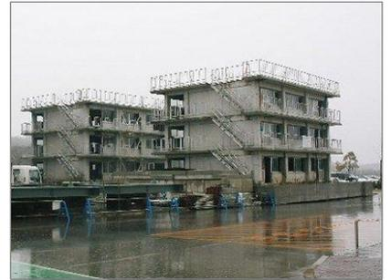
神戸波1.2倍加振して損傷した学校
